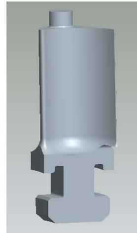
Fig. No.5.1 HP turbine blade
