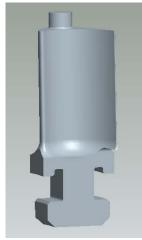
Fig. No.5.1 HP turbine blade
